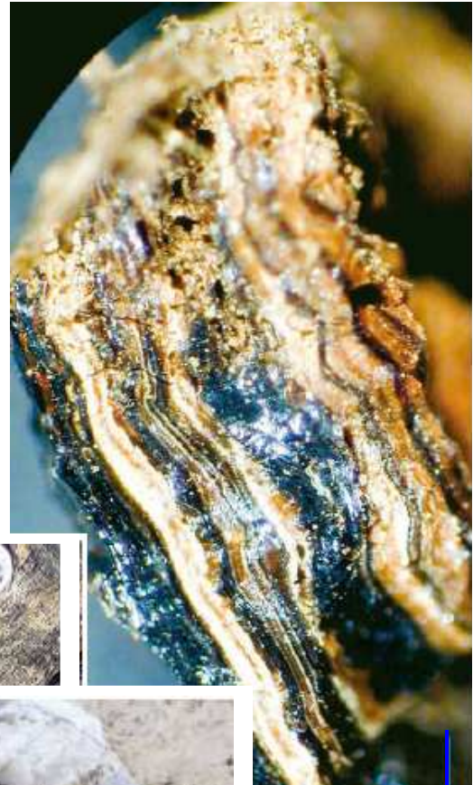
Vedere la microscop a straturilor de cristale (Struvit) [Mg(NH 4 )(PO 4 )-6H 2 O]
